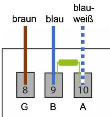
Abb. 9: Installation der Signalleitung am SDM120
