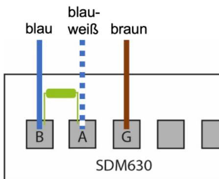
Abb. 8: Installation der Signalleitung am SDM630
