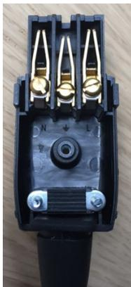
Abb. 8: Belegung des AC-Stecker
