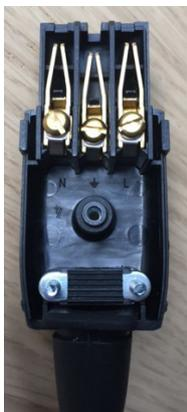
Abb. 8: Belegung des AC-Stecker
