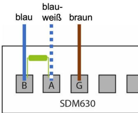
Abb. 9: Installation der Modbusleitung am SDM630
