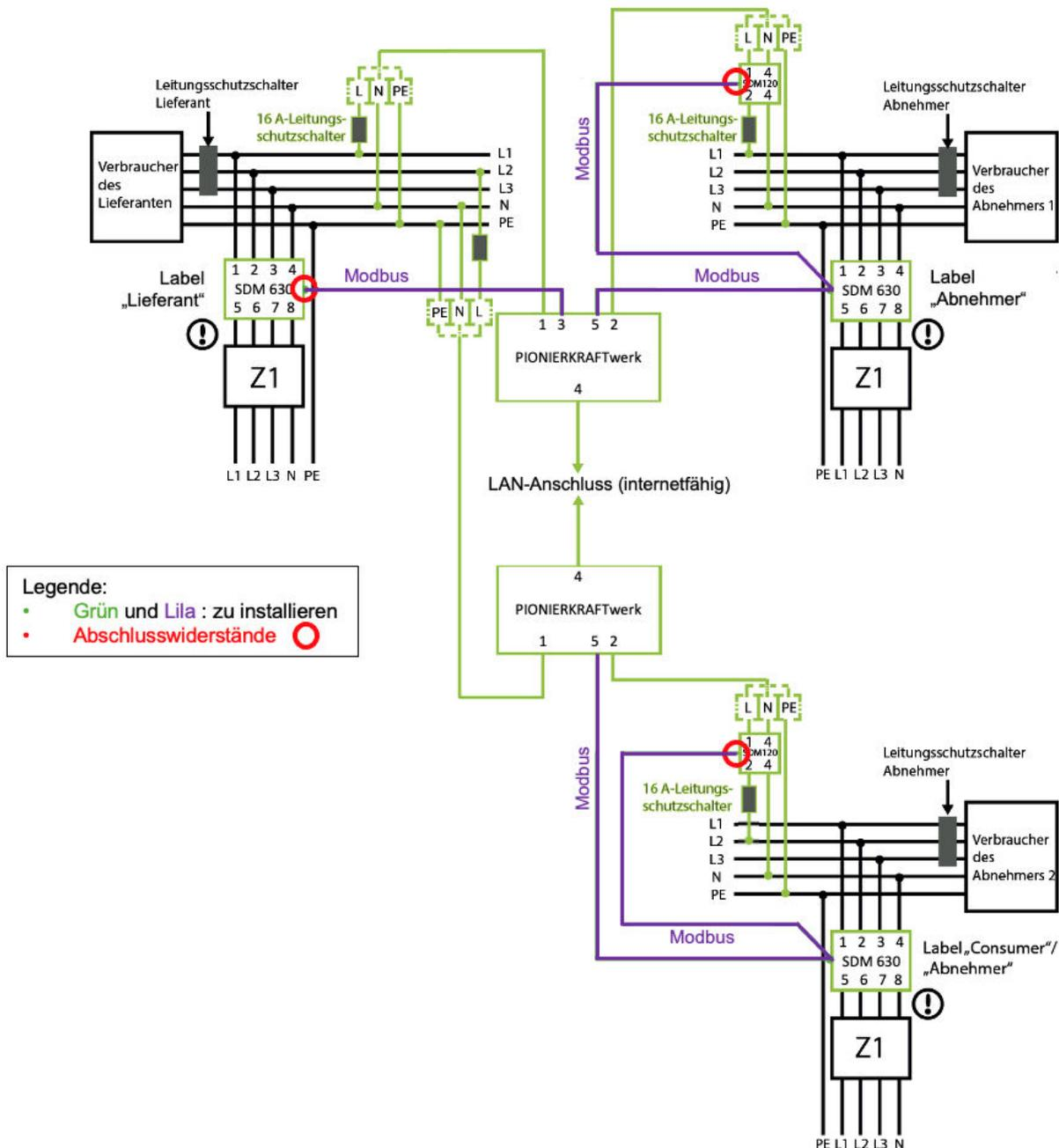
Abb. 5b: Installationsplan bei **zwei oder mehreren** PIONIERKRAFTwerken
