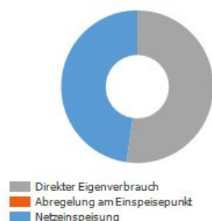
PV-Generatorenergie (AC-Netz) mit Batterie
